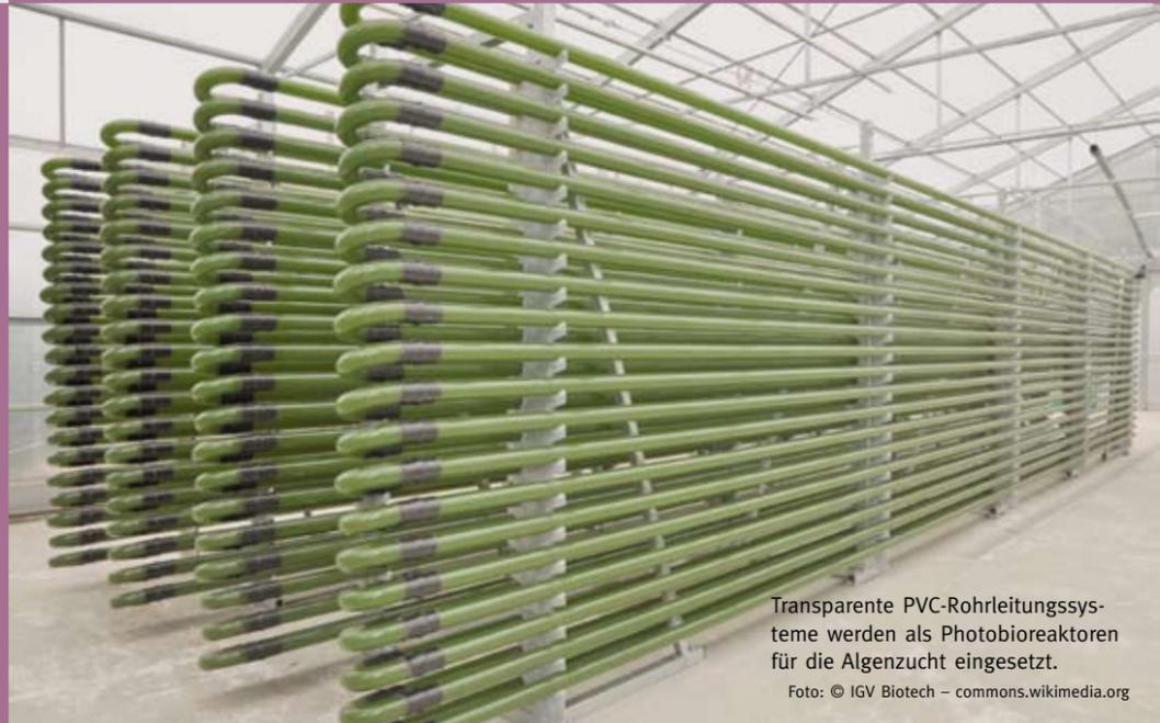
Transparente PVC-Rohrleitungssysteme werden als Photobioreaktoren für die Algenzucht eingesetzt.
