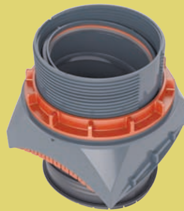
Das Kugelgelenk des PVC-Anschlusses erlaubt eine Abwinklung von 0° bis 11° und damit eine erhöhte Flexibilität und Gelenkigkeit.
