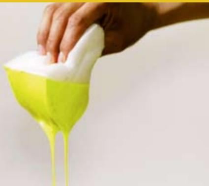
Zunächst wird ein herkömmlicher Küchenschwamm in eine PVC-Masse getaucht. Der Küchenschwamm muss mit der PVC-Paste vollgesogen sein.
