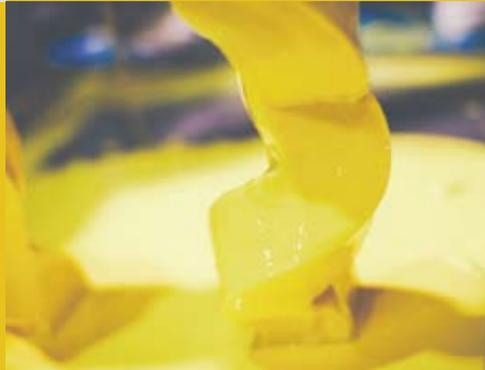
Aus mehreren PVC-getränkten Schwämmen werden die Einzelteile des Hockers geformt und anschließend mehrere Stunden lang durch Wärmezufuhr verfestigt.
