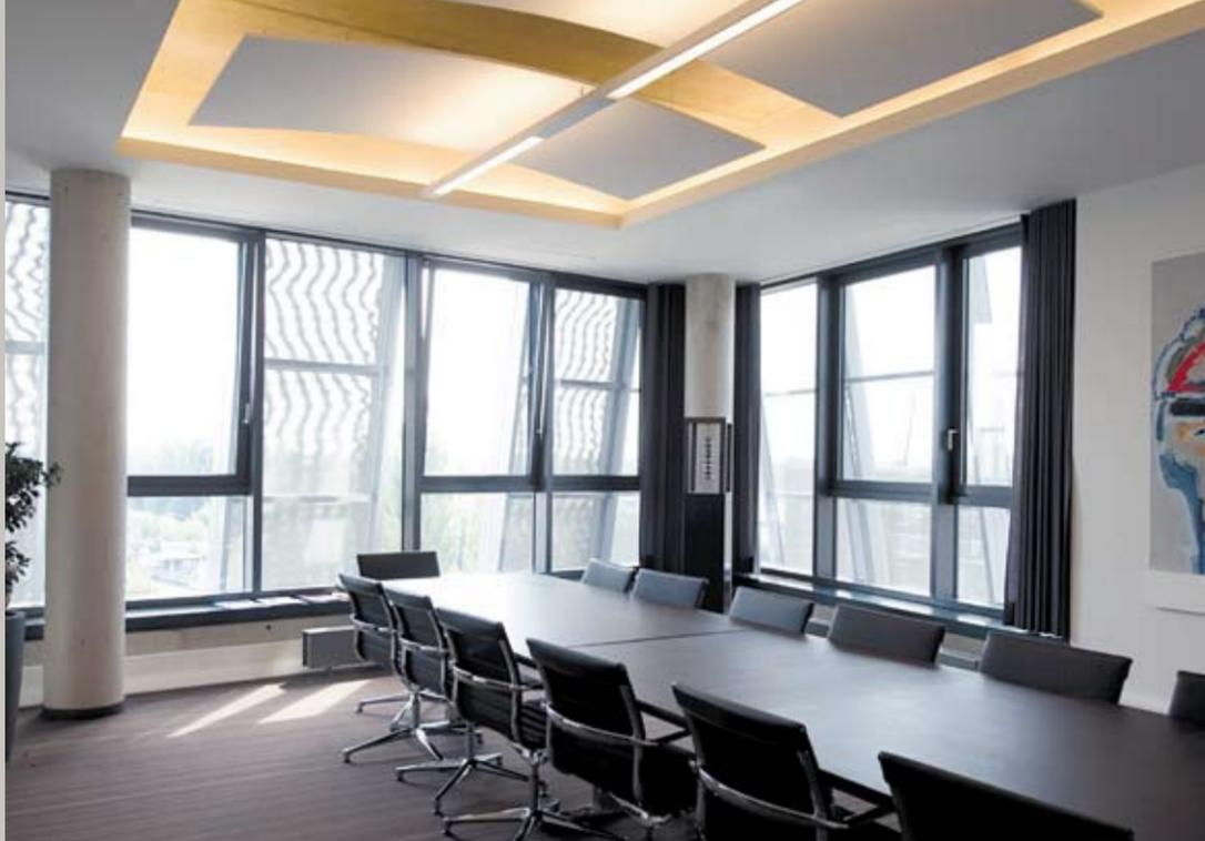
Dank der Beschaffenheit des Gewebes in den Sonnenschutzläden wird die direkte Sonneneinstrahlung abgeschirmt. Gleichzeitig bleibt die Durchsicht von innen nach außen gewährleistet.
