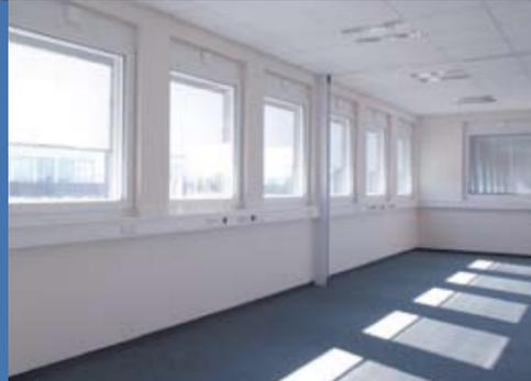
Die Frischluftzufuhr erfolgt über das Öffnen der Fenster und, wenn das nicht möglich bzw. ausreichend ist, über die Lüfter, die über den Fenstern in einem Kanal installiert sind.
